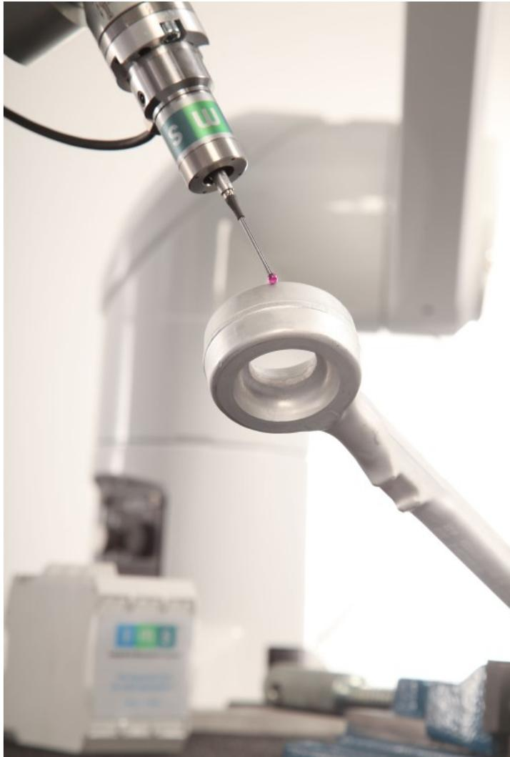
Ermittlung der räumlichen Lage des Werkstücks bezüglich des Roboterkoordinatensystems.
